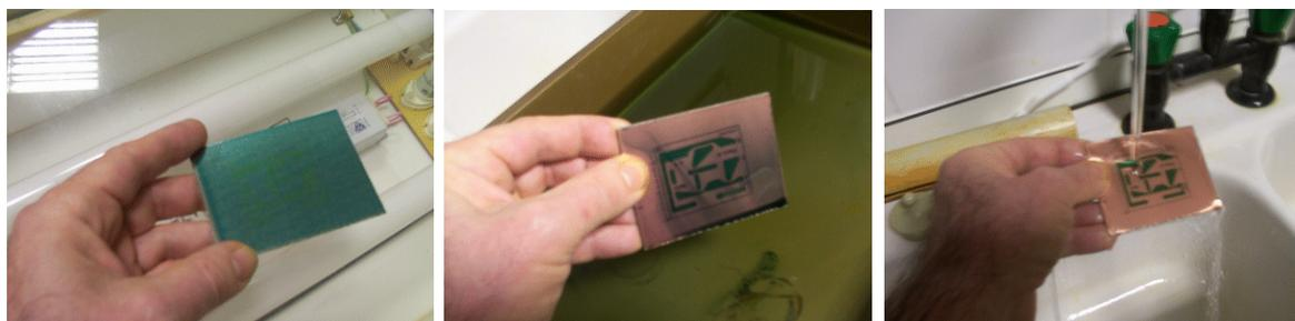
**Gravage :** Mettez la plaque à graver dans la machine à graver remplie de perchlorure de fer (voir dans le matériel de technologie). Si vous n'avez pas de machine à graver, vous pouvez effectuer l'opération dans une cuvette (cuvette photo, cuvette "à chat" ou cuvette de dissection empruntée aux collègues de SVT).
